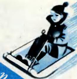
**САНИ.** На этих довольно простых по конструкции и устойчивых санях можно устраивать гонки с гор. Основанием саней служит лист трехмиллиметровой фанеры, изогнутой, как показано на рисунке. Боковинками — планки из твердых пород дерева. Длина каждой из них 120 см, ширина — 30 мм.
